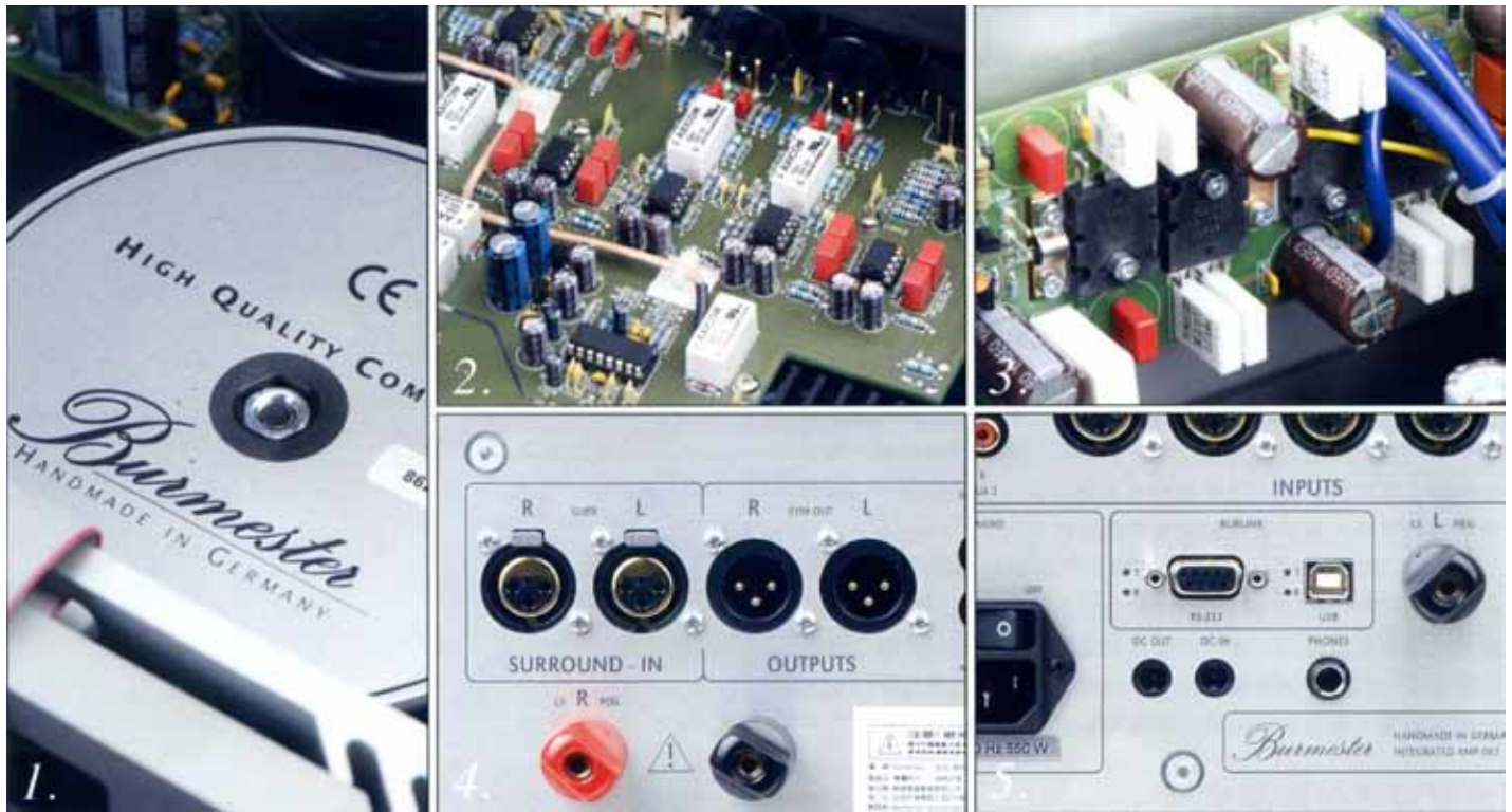
▲圖1. 450VA超大環型變壓器讓輸出內阻降至極低。圖2. 善用繼電器縮短音訊路徑。圖3. 每聲道兩對功率晶體，輸出安全餘裕加倍。圖4. Surround-in與前級輸出增加應用的彈性。圖5. 藏在後面以備不時之需的的耳機插孔。
