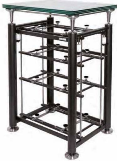
音響架中各層以鋼架設計取代常見的平台設計，每層鋼價上帶有四個隔絕腳錐，可調整位置，適合擺放各類大小的器材。整個音響架更安座在不鏽鋼圓盤狀的底座，阻絕地面傳來的震動。此外，底座與支架上的隔絕角錐分別有鐵氟龍與氣丁橡膠，具有不同隔震效果，讓使用者可依空間特性選擇使用。（極品 02-2792-9778）
