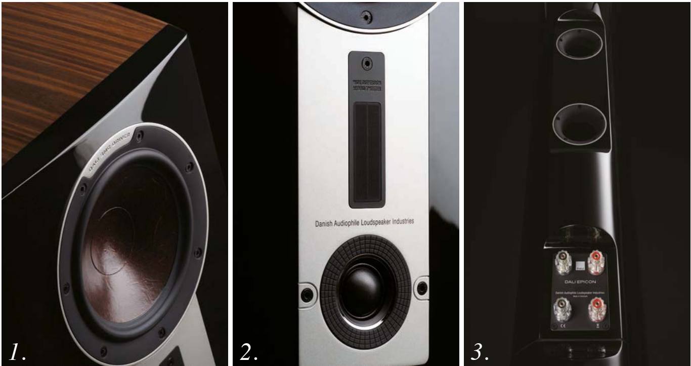
▲圖1. 獨家使用的木纖維音盆，擁有質堅、輕量的特色，能快速反應出音訊中的紋理細節。 圖2. 特製的雙高音模組，有共用的金屬障板，利用兩種不同性質高音的特性，組合出寬廣的擴散性與敏銳的沉音表現能力。 圖3. 音箱的後方有一厚達6公分，以MDF組成的的背骨，喇叭端子與低音反射口便置於其上，此一設計能大幅削減音箱的共振。
