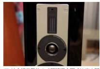
■ 結合鋁帶及軟半球單體混合而成的高音單 體模組,幾乎已成為DALI喇叭一貫的做法。
