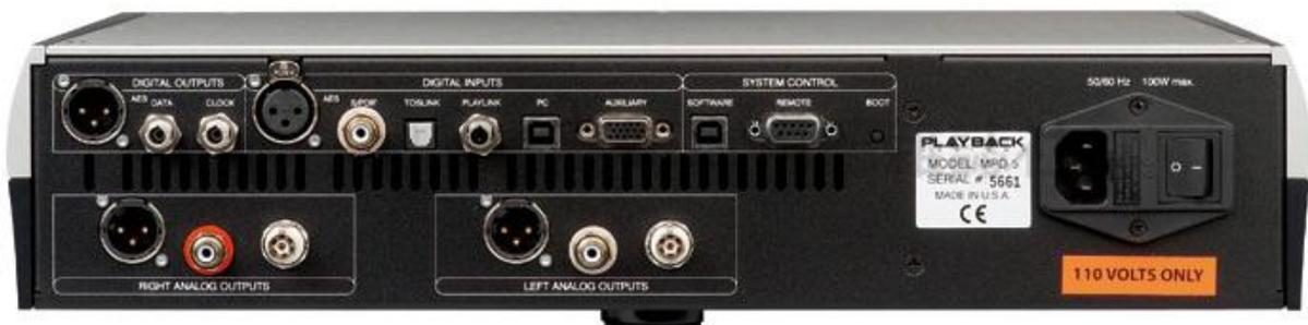
圖 2. 作為頂級 DAC，本機除提供常見的數位 AES、同軸及光纖輸入介面外，還具備可接受數位流檔案傳輸的 USB 輸入端子。AES 輸出端旁還有可將 Data 與 Clock 信號分開傳輸的 ST 光纖介面。
