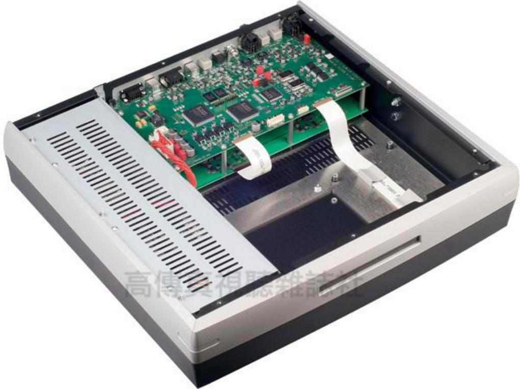
▲圖 1. MPD-5 機箱由厚實的鋁合金板構成，銀白色及黑色機身配色比例合諧，造型優雅，美感頗具。內部電路乾淨俐落，並預留加裝 Esoteric VOSP 轉盤的升級空間。
