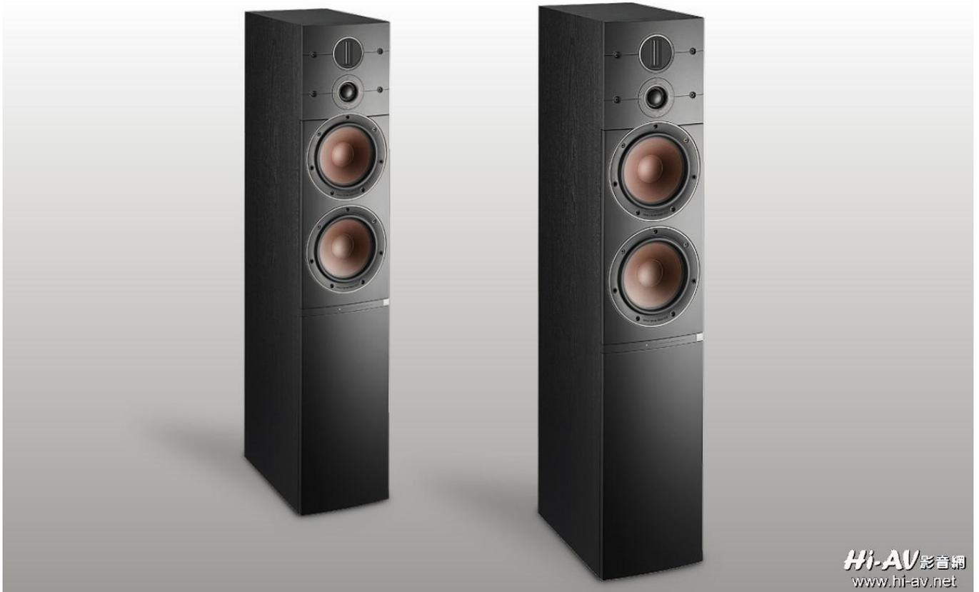
DALI Callisto 6 C 落地型喇叭高 1,004mm、寬 200mm、深 346mm，兩音路四單體低音反射式音箱架構，配備 17mm×29mm 鋁帶超高音與 29mm 絲質軟半球高音單體各一支，以及 6.5 吋中低音單體兩支，頻率響應為 37Hz-30kHz±3dB、最高音壓為 110dB、分頻點為 2,600Hz，建議離牆距離為 25 至 100 公分。雖然配備四支單體，但兩個高音模組之間並無分音器，以自然銜接來得到更低失真的極高頻延伸，兩支中低音單體併聯運作則可得到更好的極低頻延伸與量感。當然，若非像 DALI 這樣能完全掌控自家單體設計與特性的廠家，想由如此簡潔分音架構達成「完美自然銜接」是幾乎無法辦到的。
