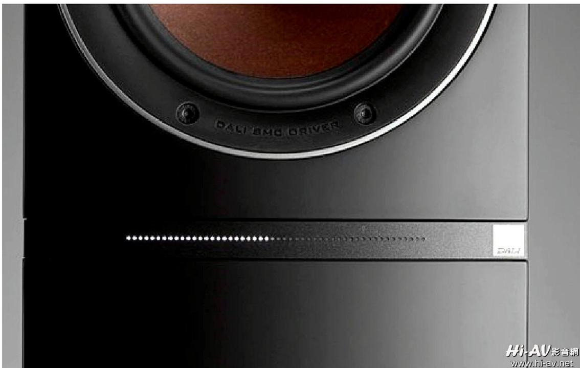
當進行音量調整之際，Callisto 系列喇叭前障板的 LED 燈號會同步產生變化。原來，DALI 在中低音單體下方設置了 52 顆 LED 燈，如此不但可明確顯示音量，還為喇叭外型增添華美的時尚科技感。
