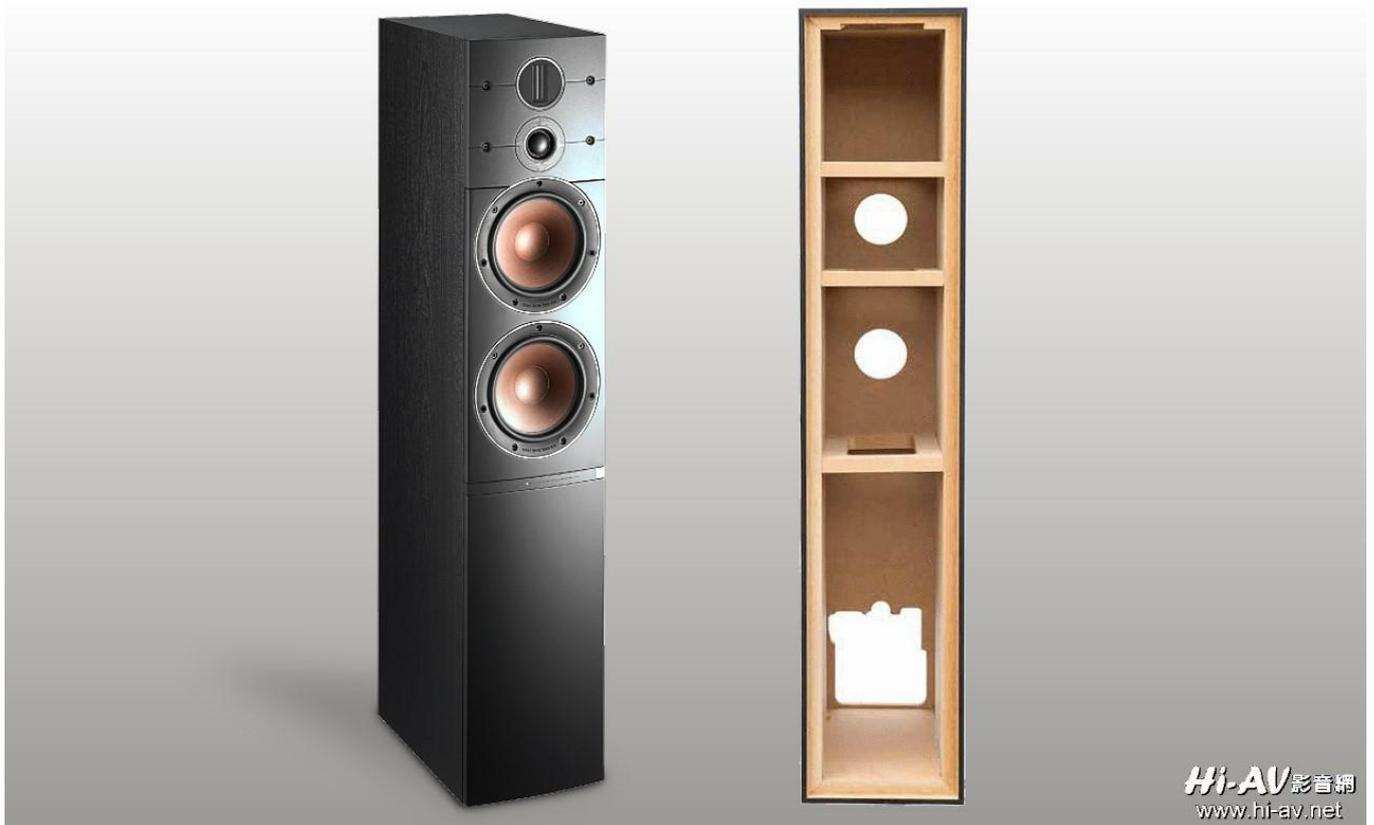
DALI Callisto 系列喇叭都是在丹麥工廠製造，並經過嚴格測試與認證。箱體採用厚達 25mm 的 MDF 板製作，內部還加入了堅固的支撐結構，以提高音箱剛性和密度，更有效地抑制箱體振動。
