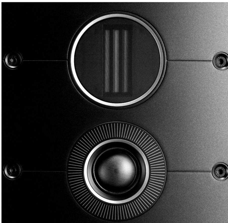
雖然沒有整合成一個模組，但 Callisto 系列喇叭高音仍沿用 DALI 高階招牌的「複合式架構」，在一支 29mm 絲質軟半球高音單體（見下方圖說）之上，再加上 17mmx29mm 鋁帶超高音之組合。當然，兩者都是 DALI 針對 Callisto 系列喇叭性能自行設計生產的，透過此設計獨特的高音模組，Callisto 系列喇叭的極高頻延伸都可輕而易舉地達到 30kHz。DALI 高音採「複合式架構」除可大幅提升極高頻延伸能力，還有加大擴散角度的好處，這是由於絲質軟半球高音在發出越高頻率時的擴散角度就越窄，因此絕大多數喇叭必須藉由 Toe-in 將喇叭前障板朝向中央，方能有精準的音像與音場，但如此一來聆聽區域就會變窄，往往只有正中央的「皇帝位」才能聽到好聲。但 DALI 由於複合模組大幅增加擴散角度，都建議用家完全不需要將喇叭 Toe-in，自然就有更為寬廣的聆聽區域範圍。
