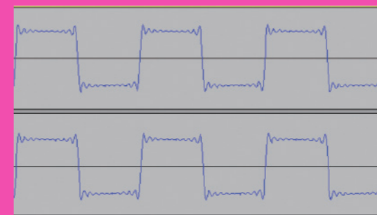
訊號輸出(上)耳擴輸出(下) 1KHz 方波表現
