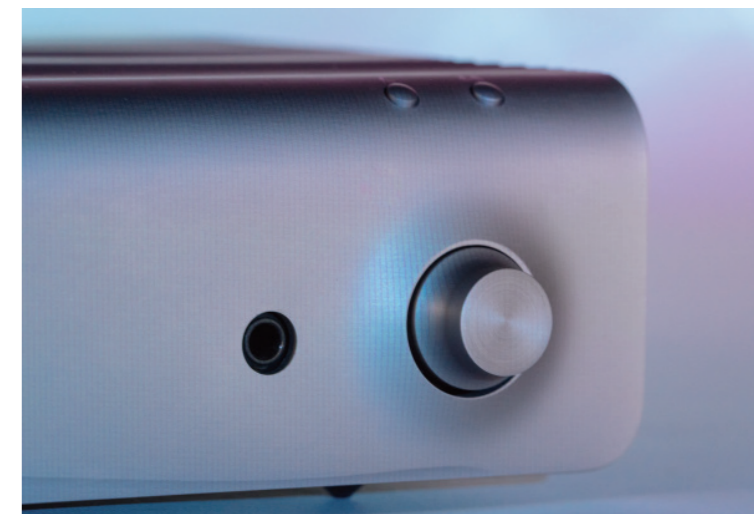
面板會顯示目前輸入的數位訊號取樣率，一旁的音量調整旋鈕只對應面板的耳機輸出，無法調整背板的訊號輸出。
