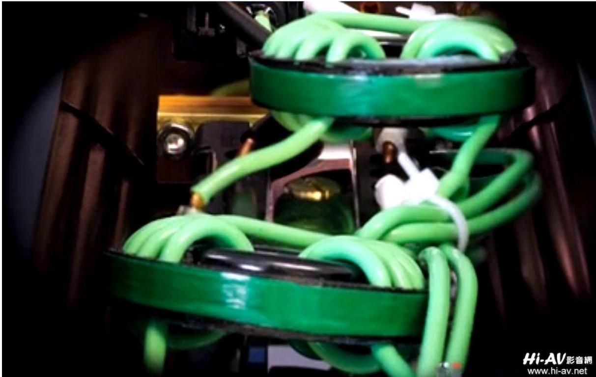
從側面的角度，可以觀察到以螺旋狀多圈環繞磁環的 Cardas Audio Grade 1 接地線。
