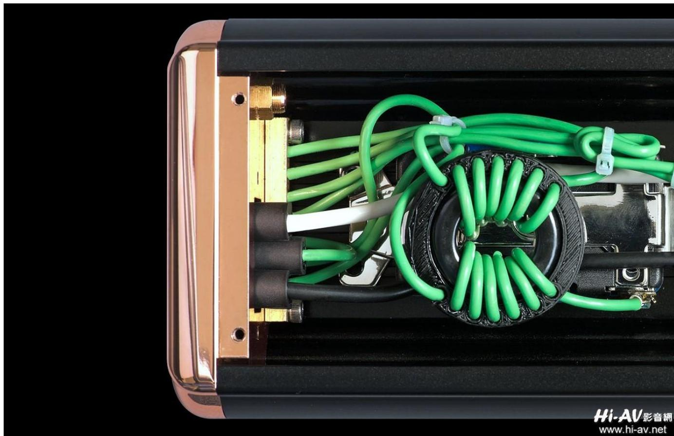
每支 Cardas Nautilus 「鸚鵡螺」電源排插配置三組共六個插孔的 4181US Duplex 電源插座，每組 4181US Duplex 電源插座的接地線都繞在各自的磁環上消除噪訊。
