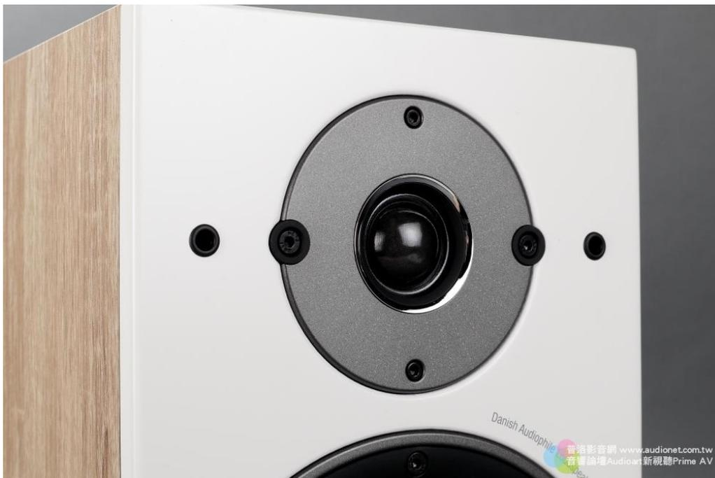
▲這次為 Oberon 系列特別設計的高音單體雖然是常見的絲質軟半球高音，不過尺寸比一般大的 29mm，比一般喇叭常用的 20mm、21mm、25mm 的絲質軟半球高音單體都大了許多，可以更輕鬆的推動空氣，失真也更低。
