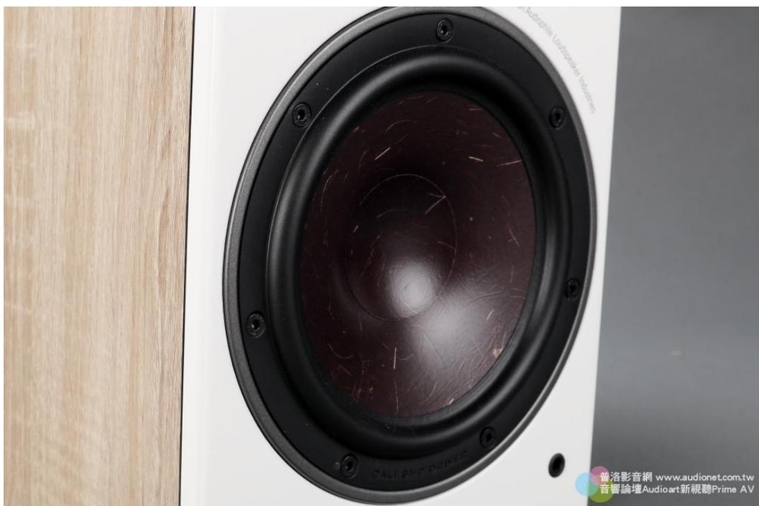
▲ Oberon3 身上的這顆 7 吋木質纖維振膜中低音單體是 DALI 專為 Oberon 系列所全新設計的製品，在中心磁極的前面五分之一處採用 SMC 材料，音圈採用輕量化的四層結構銅包鋁線圈繞製。
