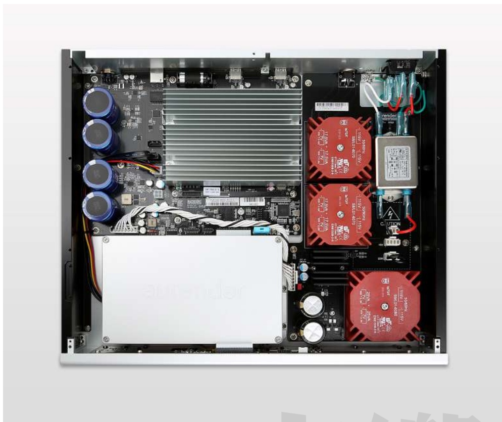
機箱內部有三個紅色環形變壓器，四個濾波電容可當暫時不斷電UPS，市電進來處還有一個濾波器。此外散熱片底下是電腦CPU，金屬盒密封的是HDD與SSD硬碟。
