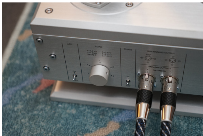
175的背面有阻抗匹配切換，還有ADP撥桿，以及相位反轉，此外就是平衡輸出端子，沒有RCA輸出。
