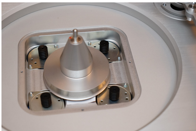
175採用四個AC同步馬達，每二個為一組驅動Platter。
