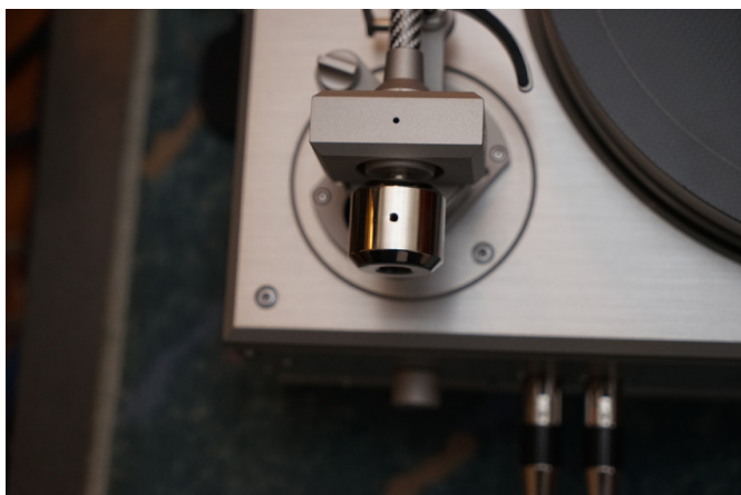
平衡錘上有一個六角螺絲，轉動平衡錘前要把螺絲鬆開。
