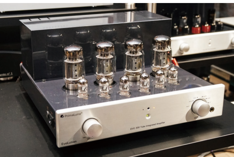
▲配上四支Electro Harmonix KT88真空管試音
