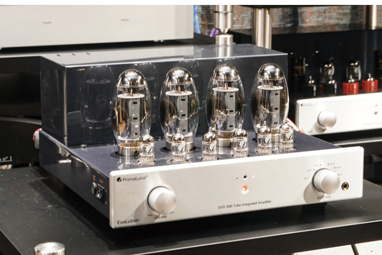
▲配上四支Electro Harmonix KT150真空管試音
