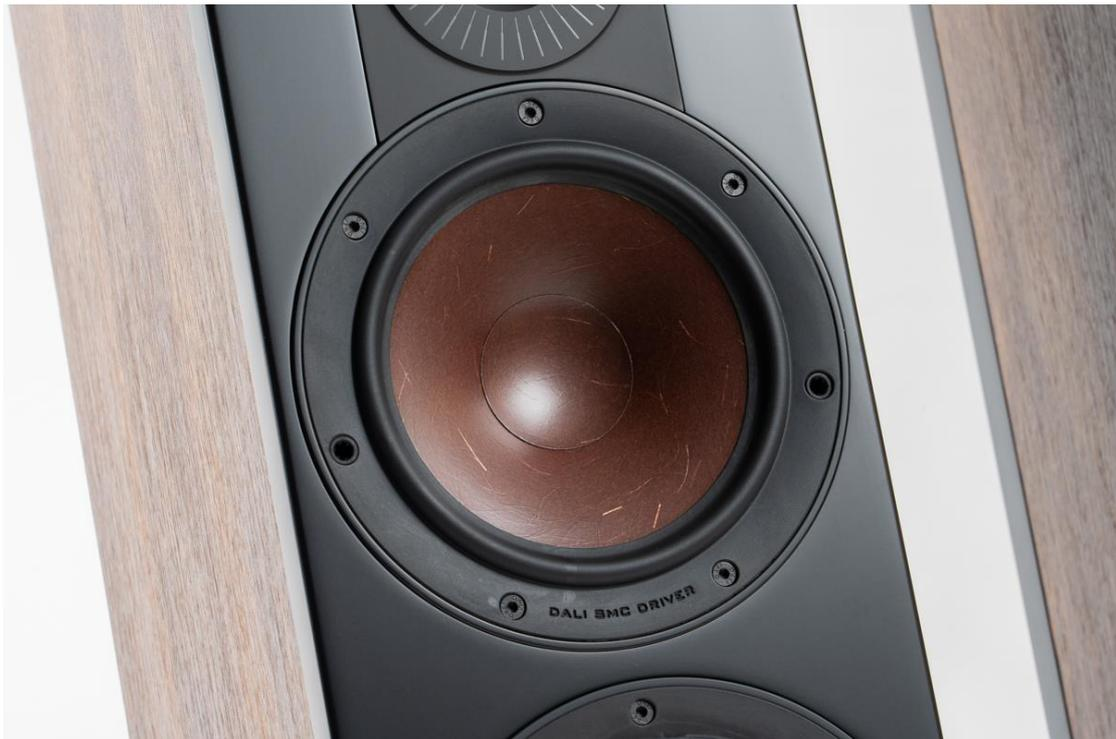
技術下放的還不只是振膜，Dali 還有一個稱為 SMC（Soft Magnetic Compound）的招牌技術，這種軟質磁性混合物是一種球狀的小顆粒，它可以被塑造成任何形狀，而由這種材料製成的磁鐵，用在喇叭上可以降低渦流效應（Eddy current）與磁滯效應（magnetic hysteresis）的影響，讓單體運動更為線性，而在低音量下仍有豐富細節且音色始終自然。
